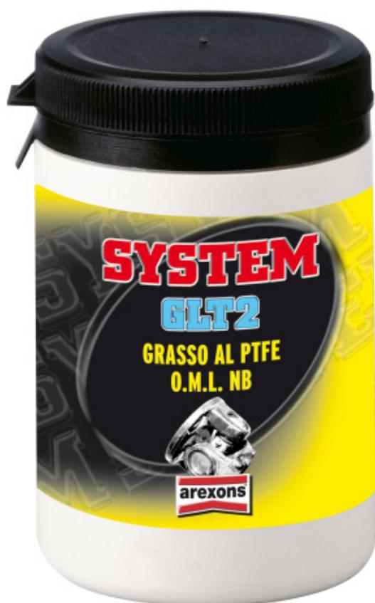
**DESCRIZIONE:** Grasso a base di olio minerale raffinato e sapone di litio complesso. Di buona qualità indicato per la lubrificazione generale di parti meccaniche funzionanti nell'intervallo da  $-25^{\circ}\text{C}$  a  $+120^{\circ}\text{C}$ . Facilita l'avviamento degli ingranaggi e migliora lo "spunto" iniziale. Additivato con ptfе (politetrafluoroetilene), che garantisce una migliore lubrificazione.
