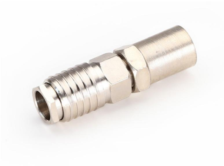
**MATERIALE:****Corpo:** Acciaio**Valvola:** Ottone**Molla:** Acciaio inox AISI 302**Guarnizione:** Gomma NBR**PRESSIONE MAX:** 16 Bar**TEMPERATURA DI ESERCIZIO:** da -18°C a +80°C**FILETTATURA:** Gas cilindrica conforme ISO 228**FLUIDI COMPATIBILI:** Aria compressa
