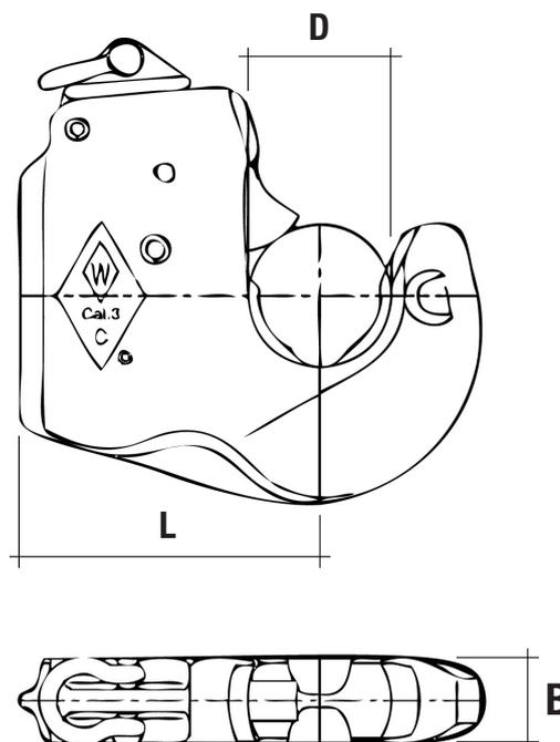
**PARTICOLARITA':** Semplice accoppiamento con traverse di centraggio. Blocco di sicurezza per evitare l'apertura accidentale. La struttura compatta garantisce più spazio per l'apparecchio. Il ridotto numero di componenti e l'apertura di uscita riduce la sensibilità alla sporcizia. Per un bloccaggio completo, è possibile fermare il chiavistello, ad es. con una vite 8x50.
