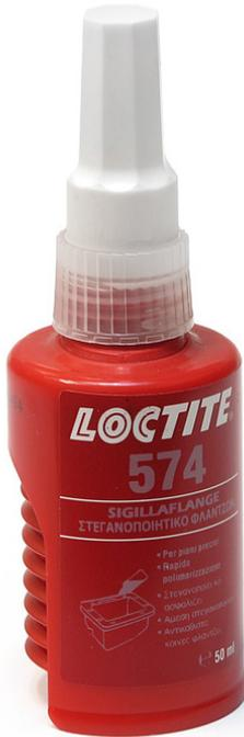
**DESCRIZIONE:** LOCTITE® 574™ sigilla giunti flangiati metallici rigidi . Il prodotto polimerizza in assenza di aria tra superfici metalliche a stretto contatto . Resiste a basse pressioni immediatamente dopo l'assemblaggio delle flange. Utilizzato come form-inplace gasket su giunti a flange rigide, es. scatola del cambio etc. La natura tissotropica di LOCTITE® 574™ evita la migrazione del prodotto liquido dopo l'applicazione.
